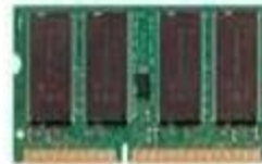
144 pin SDRAM SODIMM
