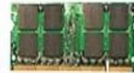
200 pin DDR-2 SODIMM
