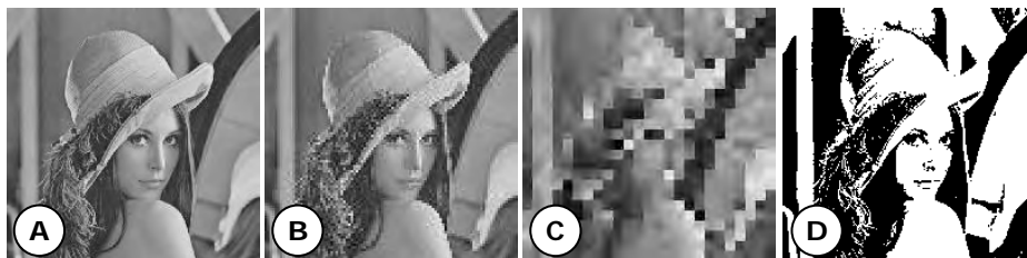
Fig. 9 – Influência da variação do número de amostras e de níveis de quantização na qualidade de uma imagem digital: (A) 200 x 200 pixels/ 256 níveis; (B) 100 x 100 pixels/ 256 níveis; (C) 25 x 25 pixels/ 256 níveis; e (D) 200 x 200 pixels/ 2 níveis.
